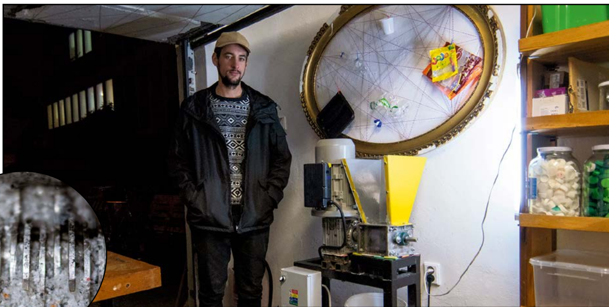
„Prvý zostrojený stroj rozseká očistené plasty na vložky a granulát, ktoré ďalej spracujeme,“ hovorí Patrik Bartas.
