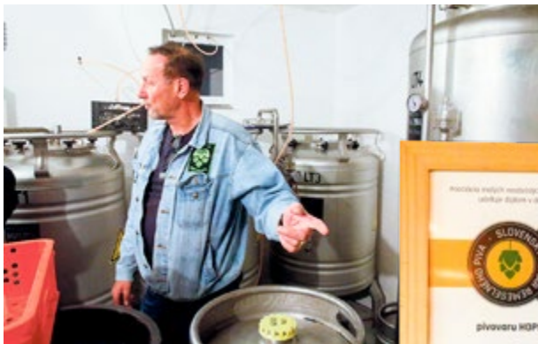
▲ Z ležiackeho tanku ide pivo cez trubky priamo do výčapu.
